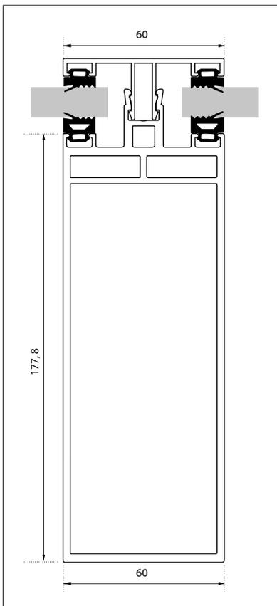
Querschnitt Pfosten TR20 (3-teilig)
